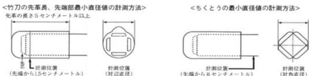
図 竹刀の先革長、先革先端部最小直径値、ちくとう直径値の計測方法
